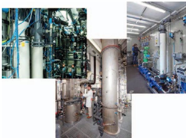
Abb. 19: Halbtechnische Versuchsanlagen zum Nachweis der Wirksamkeit, Zuverlässigkeit und Grenzen von bewährten bzw. innovativen Verfahrensstufen
